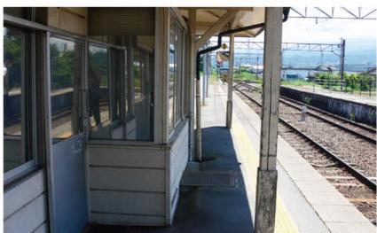
タブレット閉塞とは、同じ線路間に2つ以上の列車が走って衝突するのを防ぐために、金属製の円盤（タブレット）をもった列車だけが線路を走るようにする仕組みです。1番線プラットフォームにある飛び出した部分（写真）は、このタブレット閉塞器が置かれた箇所です。
